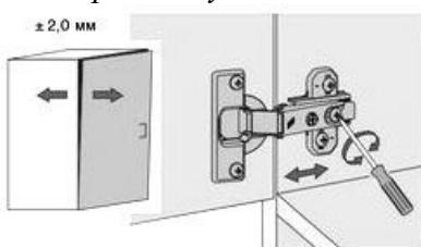
*Ослабить крепёжный винт и отрегулировать положение двери по глубине. Затем снова затянуть крепёжный винт.*
