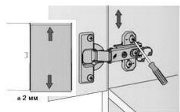
*Слегка ослабить крепёжные винты монтажной планки. Отрегулировать положение двери по высоте. Крепёжные винты снова затянуть.*
