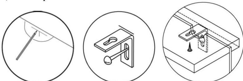
Предлагаемые дюбели предназначены для использования в стенах с полнотелыми кирпичами, силикатными полнотелыми кирпичами, бетоном или клинкерными кирпичами. Для крепления на стенах из другого материала следует использовать имеющиеся в продаже специальные крепежные элементы.
