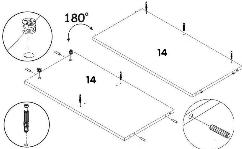
На верхнем щите **9** в установленные муфты эксцентриковых стяжек ввернуть дюбели.
