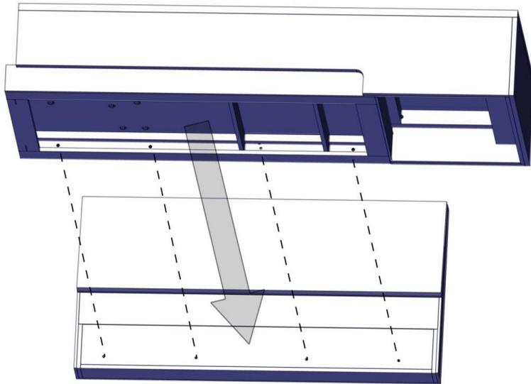
2.1. Расстегнуть молнию на дне основания, чтобы получить доступ к отверстиям. Вернуть винты в гайки.
