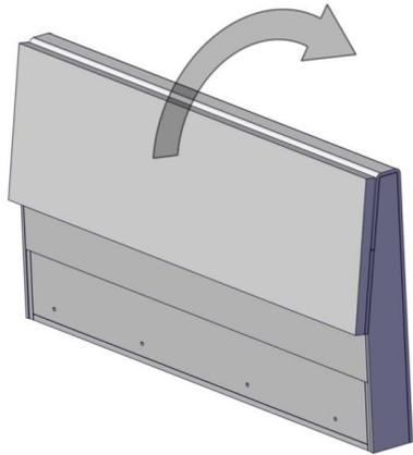
2. Поворотный модуль (основание + сидение) закрепить к спинке четырьмя винтами M8x80.
