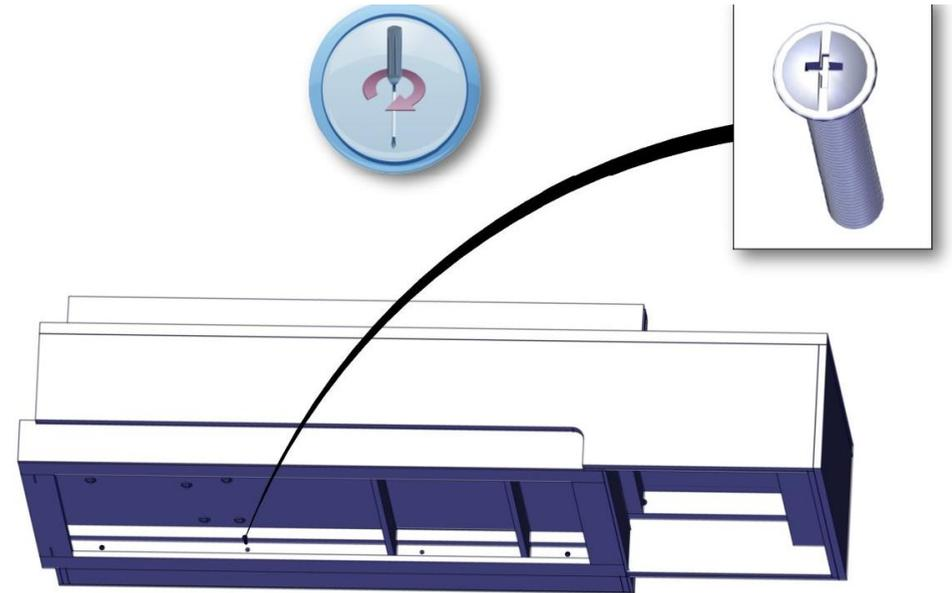
2.2. Снять транспортировочную планку.
