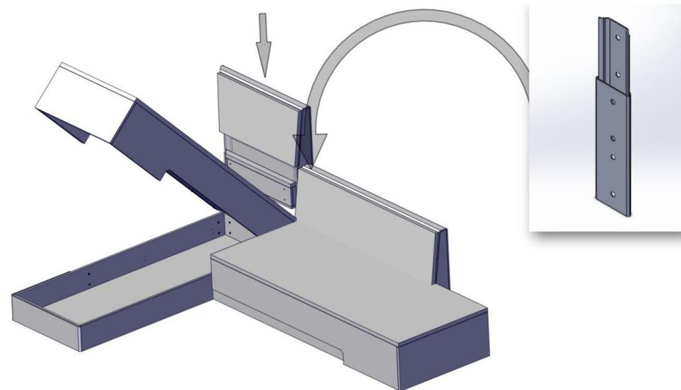
3. Присоединить к поворотному модулю оттоманку с помощью двух винтов M8x80.
