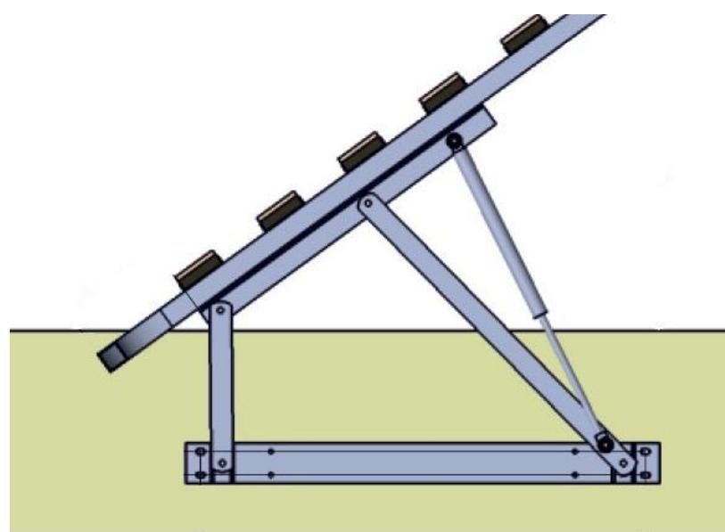
11. На кронштейнах механизма подъёма с помощью винтов M8x40 впотай и гаек M8 с прессшайбой закрепить основание.
