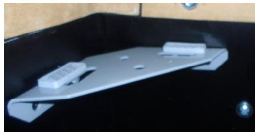
9. На царгах долевых винтами M8x20 с полукруглой головкой закрепить полки, винтами M6x20 с полукруглой головкой – кронштейны механизма подъёма.
