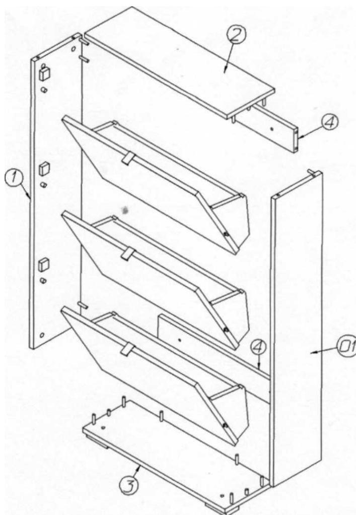
9. Соединить стенку вертикальную с планками стяжными 4 так, чтобы дюбели стяжек вошли в соответствующие отверстия в торцах. Повернуть эксцентрики на 180 градусов.
