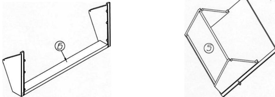
7. Установить пластиковые боковины на фасад, закрепив их шурупами 3,5x13 по имеющимся наконкам. В отверстия на кромках фасада вставить металлический полкодержатель (ось вращения). Между кромкой фасада и бортиком полкодержателя необходимо проложить металлическую шайбу.
