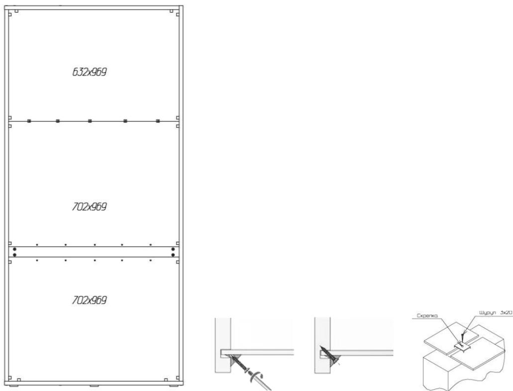
9. Собранный корпус проверить на прямоугольность, сравнивая диагонали (их длины должны быть равны). Прямоугольное положение корпуса зафиксировать с помощью мебельных уголков с шурупами. К планке **Ш.25** задние стенки крепить саморезами с прессшайбой 4,2x16. В местестыка задние стенки закрепить скрепками с шурупами 3x20мм впотай.
