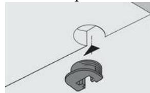
14. Между стенками вертикальными **Ш.30, Ш.31** установить стенку горизонтальную **Ш.23** так, чтобы дюбели стяжек и шканты вошли в соответствующие им отверстия. Затянуть эксцентрики, повернув их на 180 градусов.
