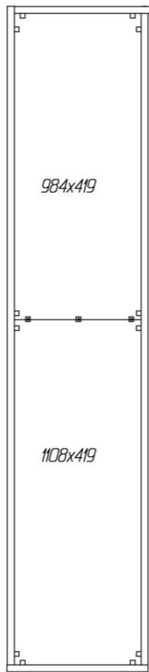
18. Собранный корпус проверить на прямоугольность, сравнивая диагонали (их длины должны быть равны). Прямоугольное положение корпуса зафиксировать с помощью мебельных уголков с шурупами. В местах стыков задние стенки закрепить скрепками с шурупами 3x20мм впотай.
