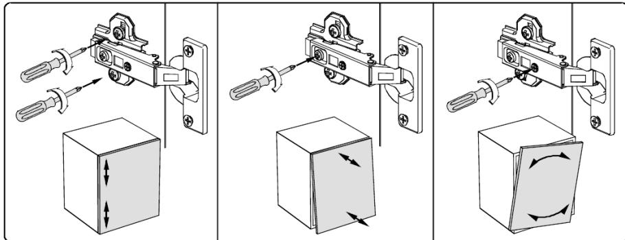
26. Установить створку крепежную на корпус (см. инструкцию из комплекта фурнитуры Wing Line L). Отрегулировать положение всех фасадов.
