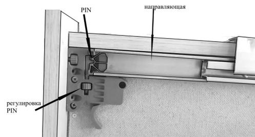
Отрегулировать PIN замка: приложить направляющую, PIN замка должен войти в паз на направляющей
