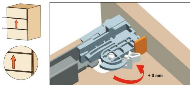
Поверните рычаг по направлению к фасаду ящика, чтобы отрегулировать его высоту
