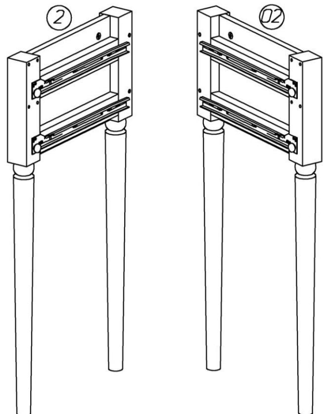
4. В отверстия на задних ножках ввернуть дюбели стяжек. В парные отверстия на передних ножках вставить шканты, в отверстия диаметром 5мм на деталях **2**, **02** ввернуть дюбели стяжек, в отверстия диаметром 15 мм вставить эксцентрики.
