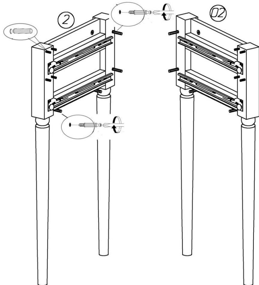
5. К стенке горизонтальной **30** при помощи конфирматов 7x50 закрепить стенку заднюю **21** и щит жесткости **22**. В отверстия диаметром 15 мм вставить эксцентрики. Стрелка на эксцентрике повернута в сторону кромки.
