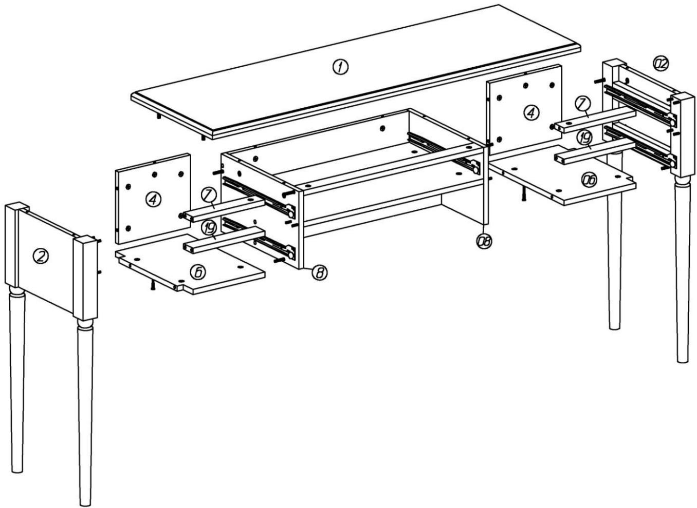
10. Соединить стенку горизонтальную с задней стенкой конфирматом 7x50.
