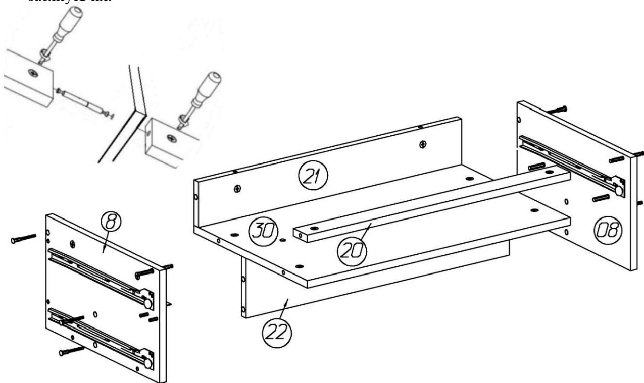
8. На перегородках **8, 08** со стороны, где две направляющие, в отверстия диаметром 5 мм ввернуть дюбели эксцентриковых стяжек, в отверстия диаметром 6 мм вставить шканты. На деталях **4, 6, 06, 7** в отверстия вставить эксцентрики.
