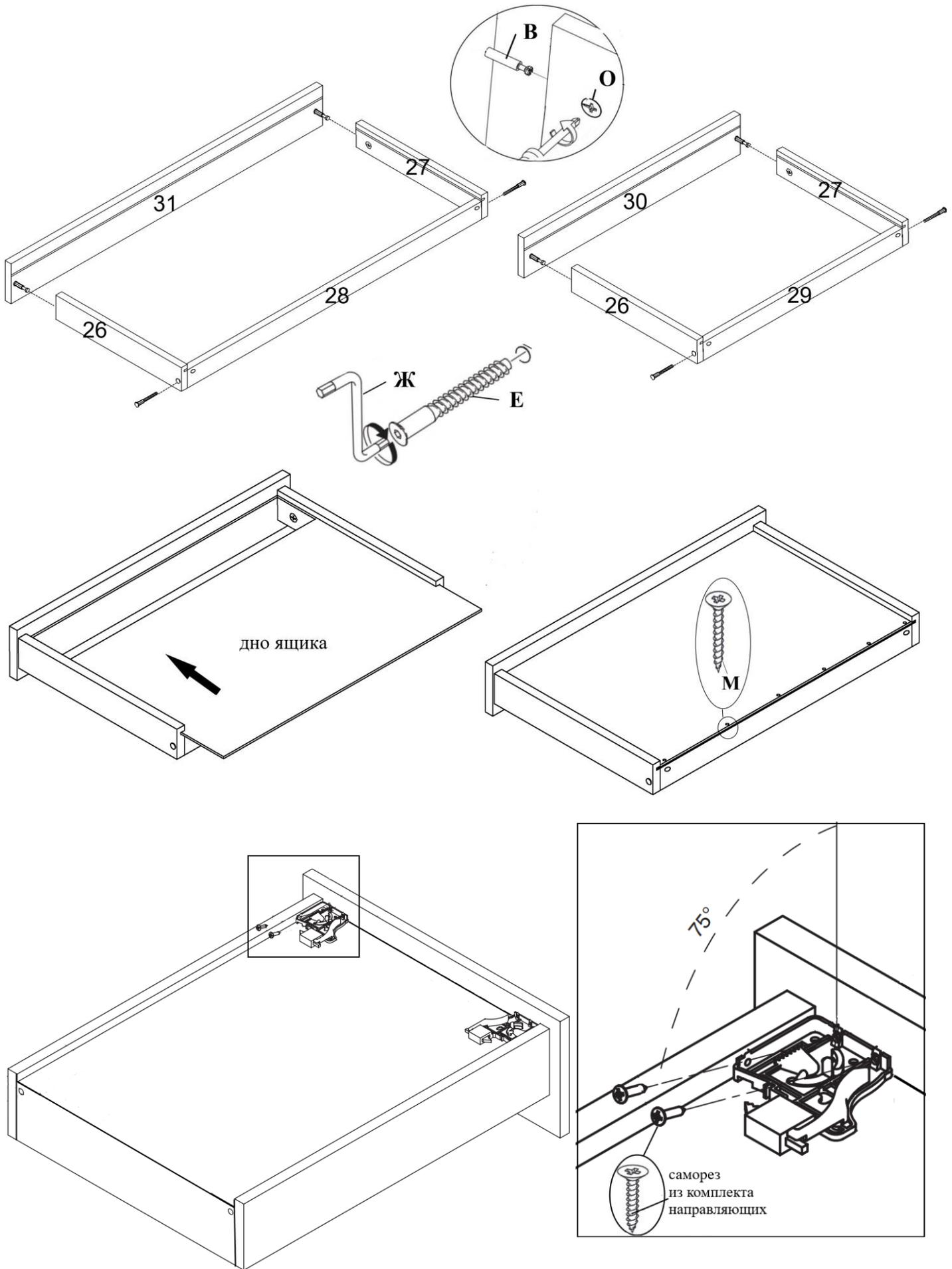
Будьте предельно аккуратны, саморезы вворачиваются под углом 75° !
