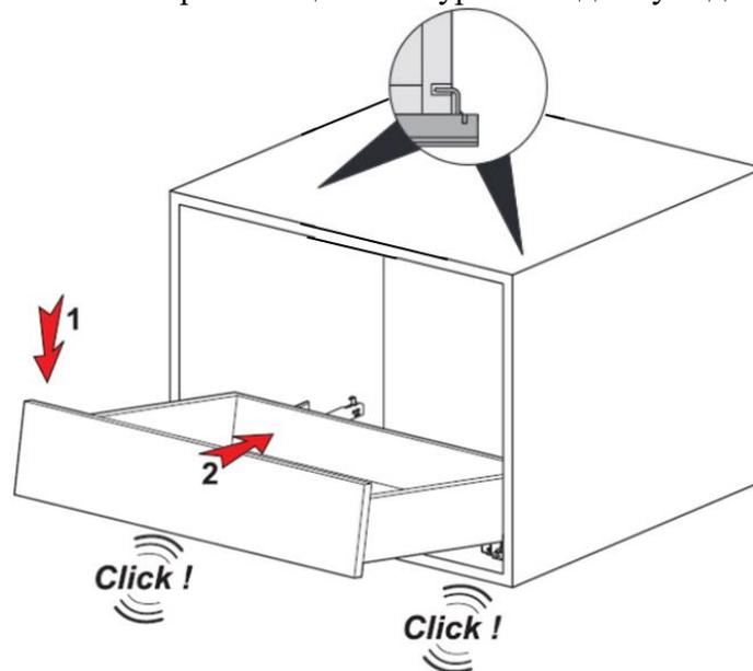
Регулировка и демонтаж ящика выполняются с помощью замков
