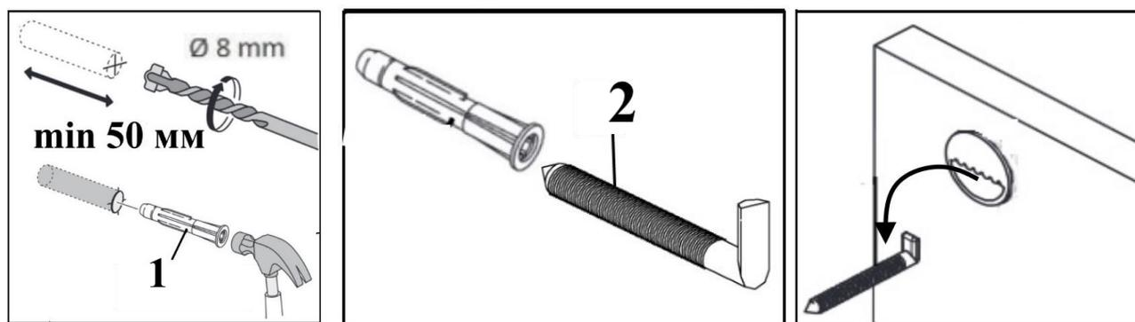
**Внимание!** Предлагаемые дюбели предназначены для использования с полнотелыми кирпичами, силикатными полнотелыми кирпичами, бетоном или клинкерными кирпичами. Для крепления на стенах из другого материала следует использовать имеющиеся в продаже специальные крепежные элементы.
