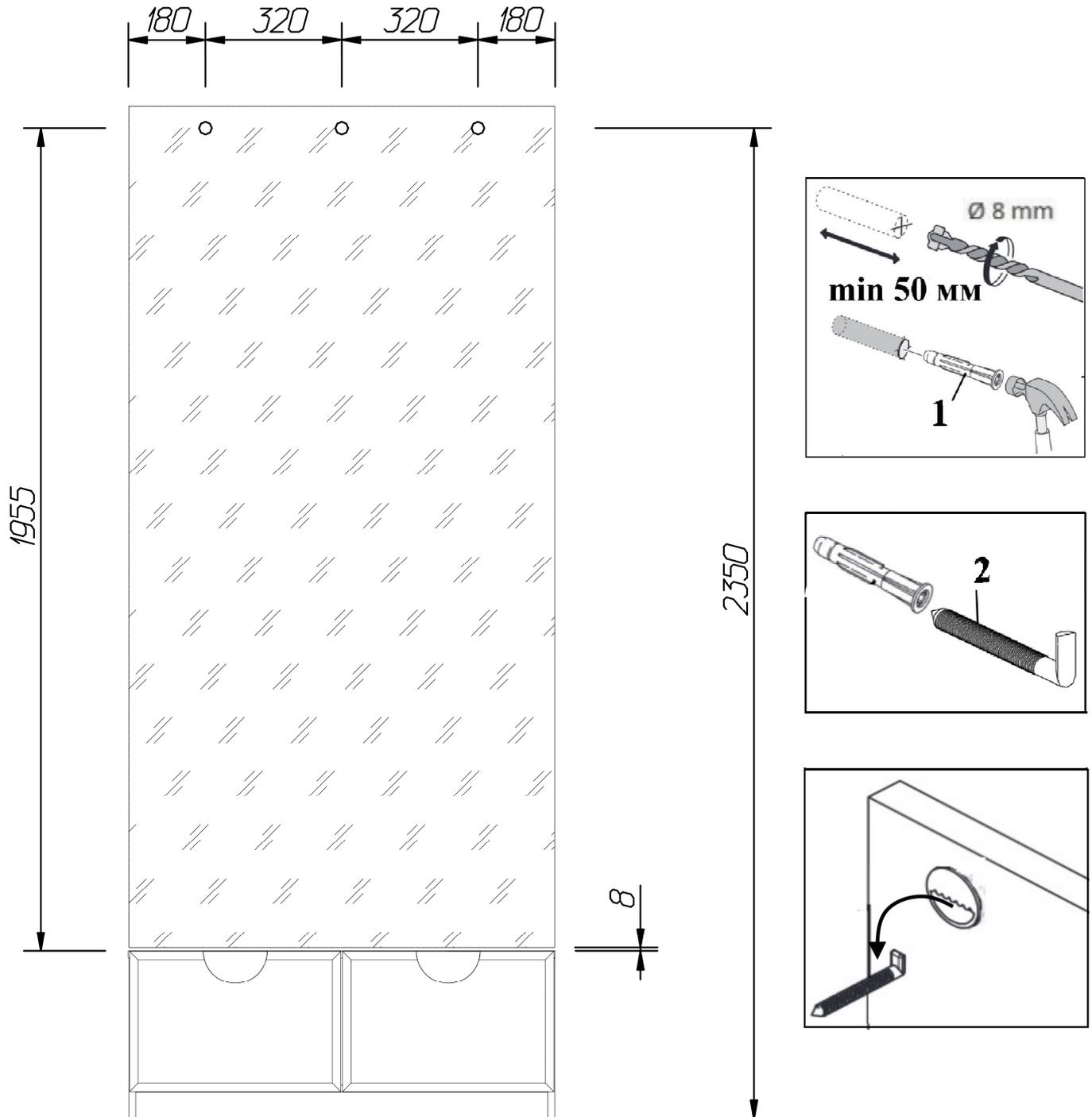
**Внимание!** Предлагаемые дюбели предназначены для использования с полнотелыми кирпичами, силикатными полнотелыми кирпичами, бетоном или клинкерными кирпичами. Для крепления на стенах из другого материала следует использовать имеющиеся в продаже специальные крепежные элементы.
