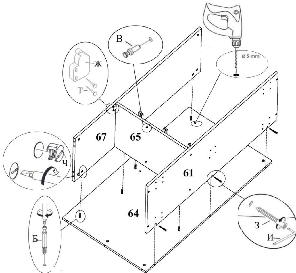
Для крепления к стене досверлить отверстия d5/d9 насквозь.
